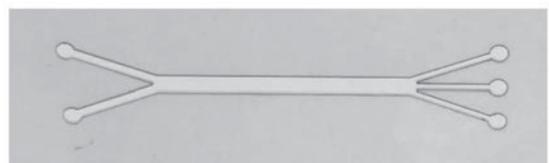
写真5 機能性フィルムのレーザー加工による流路
