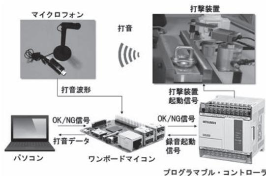
図3 打音検査システム構成
